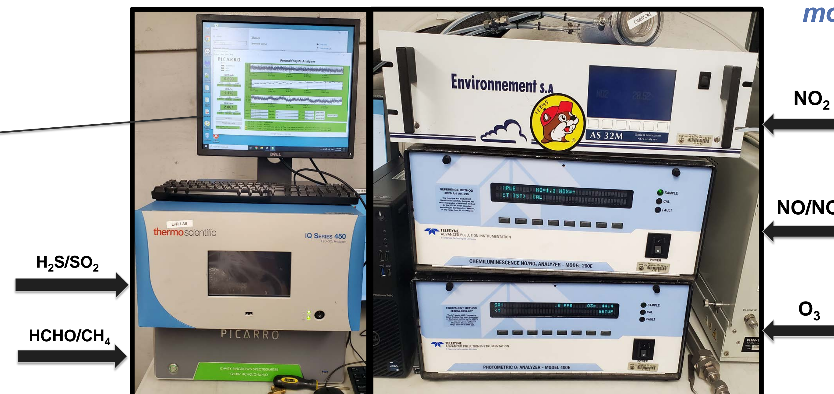
Monitor setup in stationary trailer with arrows indicating which monitors measure which molecules Configuración de monitoreo en el trailer estacionario con flechas indicando las moléculas que monitorea.
