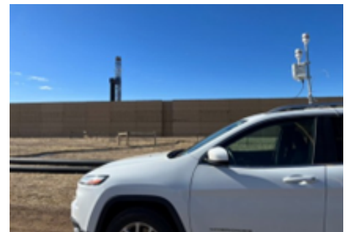
Monitoreo móvil de la calidad del aire cerca de la plataforma de un pozo en North Front Range durante las operaciones de perforación.
